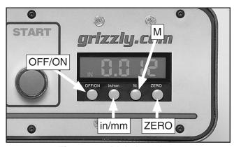
Figure 25. Digital readout.
